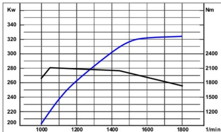
**196 Die Abbildung zeigt die Volllastkurven eines Dieselmotors.**
