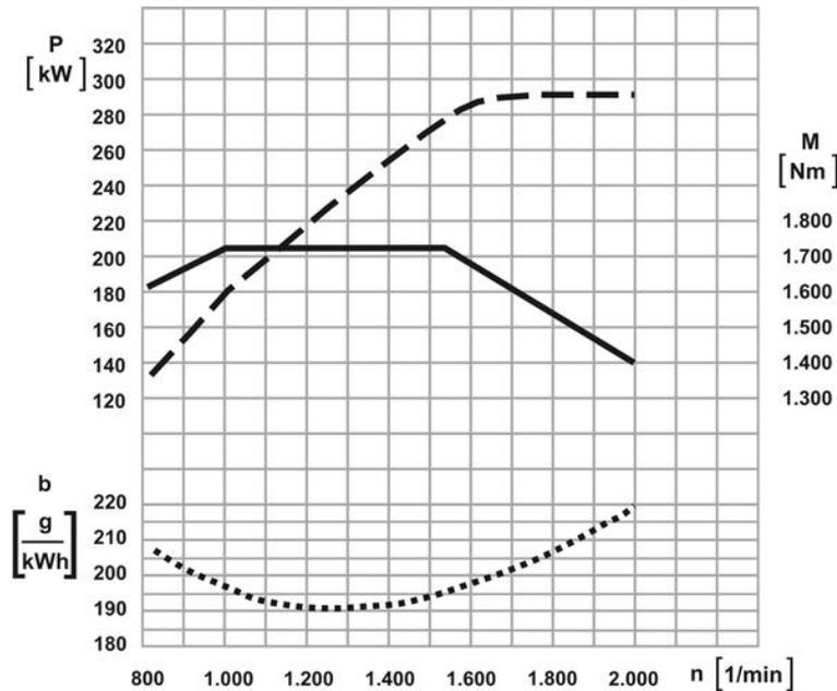
**17 Bei welcher Drehzahl erreicht der Motor sein maximales Drehmoment? (1,00 P.)**
