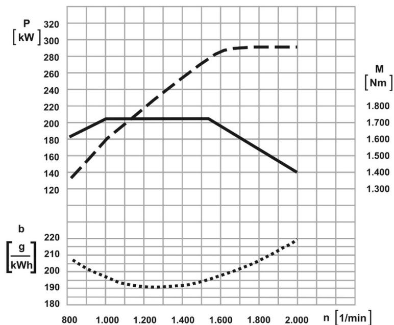
18 Bei welcher Motorleistung erreicht der Motor im Diagramm das höchste Drehmoment? (1,00 P.)
