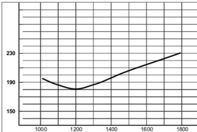
15 Über welchen Drehzahlbereich erstreckt sich der "elastische Bereich" des Motors laut dem unten abgebildeten Diagramm? (2,00 P.)
