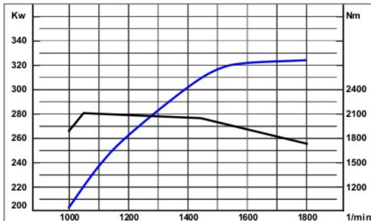
**32 Geben Sie die Leistung des Motors bei 1.600 1/min an. (1,00 P.)**
