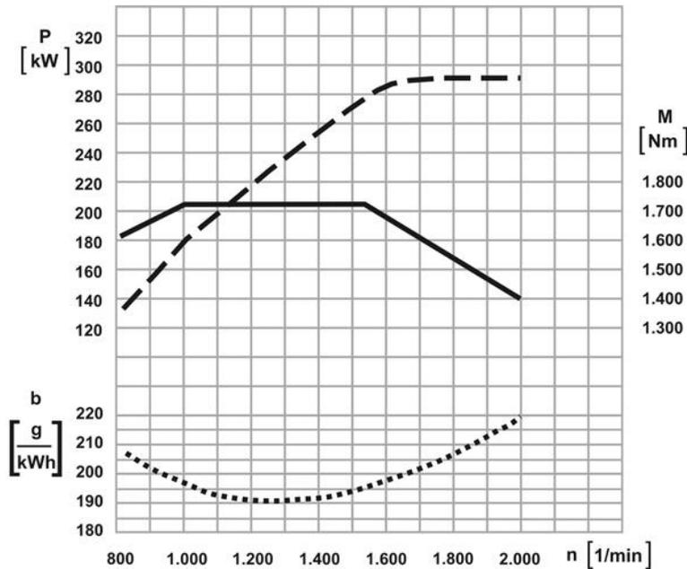
**14 In welcher Einheit wird der Verbrauch bei der Verbrauchskennlinie eines Motors angegeben? (1,00 P.)**
