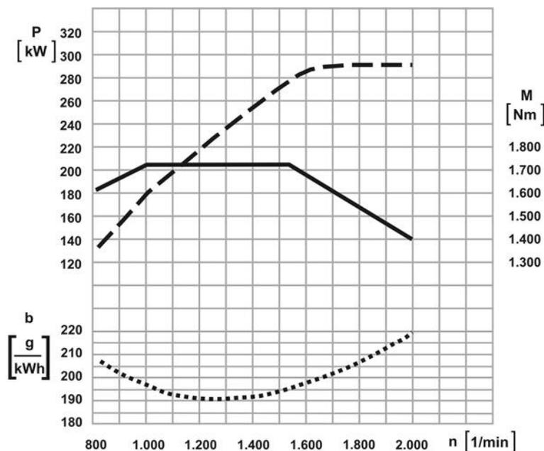
**13 Bei welcher Drehzahl erreicht der Motor seine maximale Motorleistung? (1,00 P.)**
